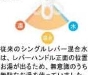
従来のシングルレバー混合水栓は、レバーハンドル正面の位置でお湯が出るため、無意識のうちにお湯が混じる位置はクリックでお知らせします。
